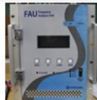
GIS 부분 방전 측정 장치
